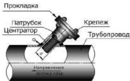
Рисунок 2.20 – Установка центратора в патрубок
