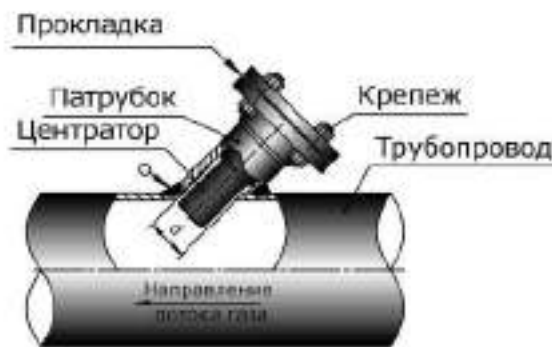
Рисунок 2.20 – Установка центратора в патрубок
