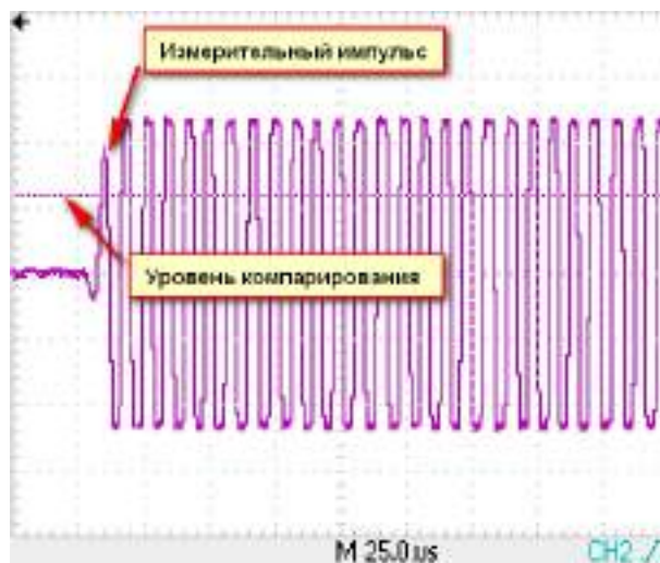
Рисунок 1.5 – Сигнал с выхода оконечного усилителя
