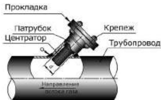
Рисунок 2.20 – Установка центратора в патрубок
