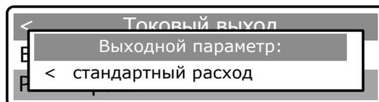
Диапазон расходов газа, который будет отображаться на токовый выход, задается с помощью параметров Q min и Q max.
