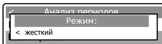
Подпункт «Медианный фильтр» управляет фильтром, обеспечивающим подавление выбросов (кратковременных резких изменений) сигнала мгновенного расхода газа.
