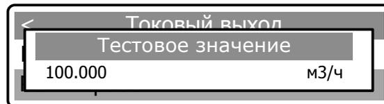
Переключение в режим редактирования осуществляется с помощью повторного нажатия клавиши [ВВОД], перемещение между цифрами – с помощью клавиш [←] [→]. Активная цифра выделяется подчеркиванием.
