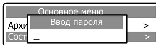
– после ввода пароля с помощью клавиш [↑] [↓] и [ВВОД] просмотреть значение процентного содержания компонентов газа и плотности газа
