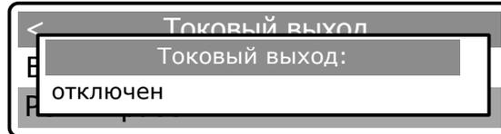
Повторным нажатием клавиши [ВВОД] производится включение/выключение токового выхода.
