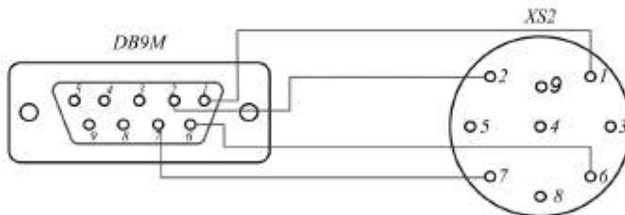
Рисунок Л.3 – Схема подключения ВТ и ПР
