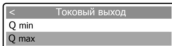
Заводские установки: Q min = 0, Q max = максимальному значению измеряемого расхода газа для данного ПР.
