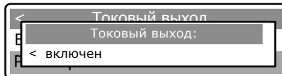
В выключенном состоянии токовый выход обеспечивает ток 4 мА независимо от расхода газа.
