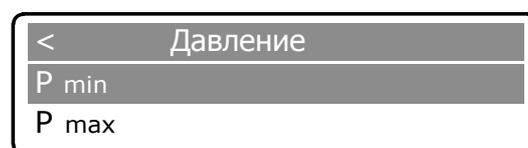
Ввод минимального значения давления выполняется в следующей последовательности: Клавишами **[↑]** **[↓]** выбрать параметр «Pmin» и подтвердить нажатием **[ВВОД]**.
