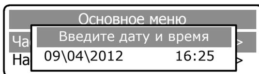
В открывшемся окне установить текущую дату и время. Переключение в режим редактирования осуществляется с помощью повторного нажатия клавиши [ВВОД]. Установка времени / даты осуществляется с помощью клавиш [ 0 ] - [ 9 ], перемещение между цифрами – с помощью клавиш [ ← ] [ → ]. Активная цифра выделяется подчеркиванием.
