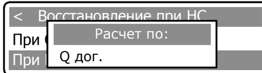
Повторным нажатием клавиши **[ВВОД]** активизируется режим выбора варианта значения расхода используемого при нештатной ситуации: Q дог. Или Q ср.
