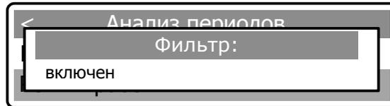
Повторным нажатием клавиши **[ВВОД]** производится включение/выключение фильтра.
