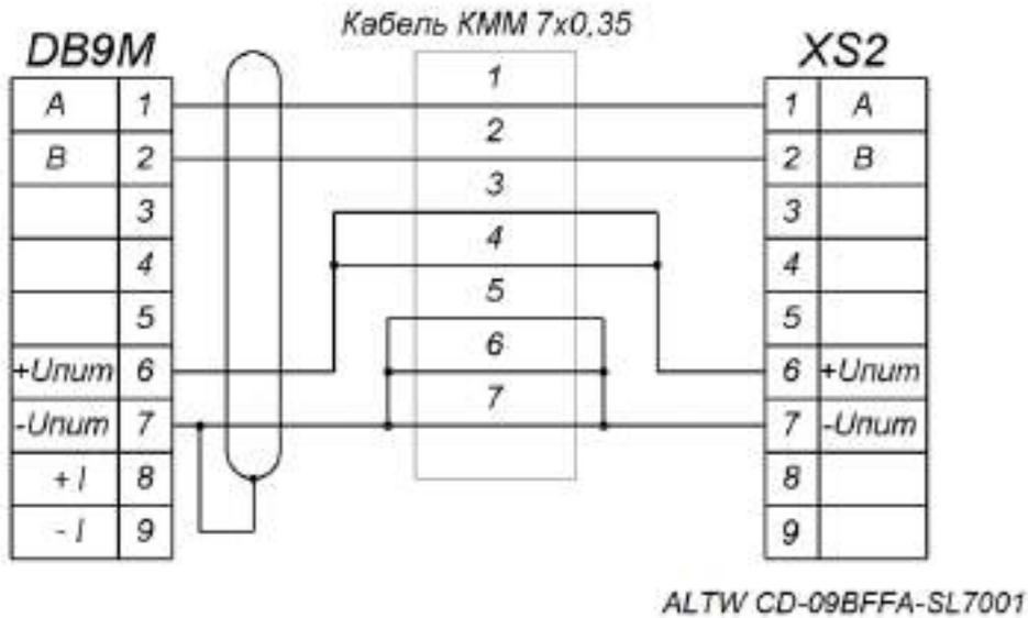
Рисунок Л.1 – Схема распайки кабеля КММ 7x0,35 для подключения ВТ и ПР
