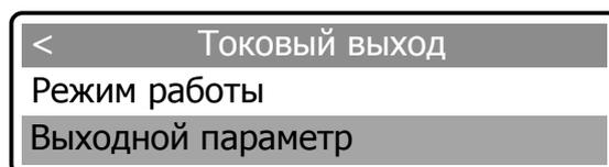
С помощью клавиш [↑] [↓] выбрать подпункт «Выходной параметр» и подтвердить нажатием [ВВОД].
