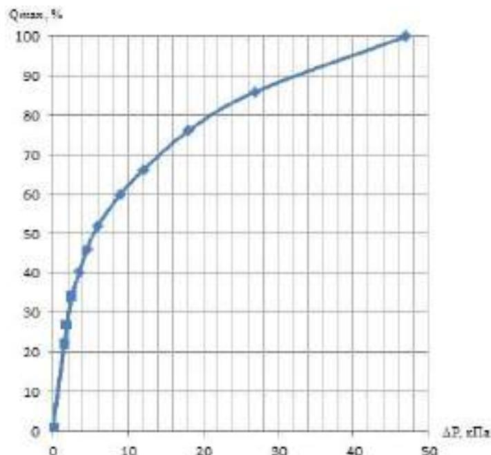
Рисунок 3 – Зависимость расхода от перепада давления
