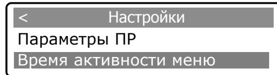
Ввод параметра (в секундах) осуществляется с помощью повторного нажатия клавиши **[ВВОД]**, после чего активная цифра выделяется подчеркиванием (режим редактирования). Изменение значений – клавишами [ 0 ]-[ 9 ], перемещение между цифрами – с помощью клавиш [ ← ] [ → ].
