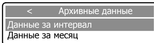
В открывшемся окне установить дату и время начала отчетного периода. Установка времени / даты осуществляется с помощью клавиш [ 0 ] - [ 9 ], перемещение между цифрами – с помощью клавиш [ ← ] [ → ]. Активная цифра выделяется подчеркиванием.
