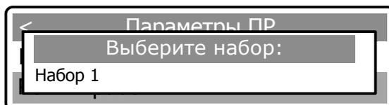
Повторным нажатием клавиши [ВВОД] производится включение/выключение набора коэффициентов.
