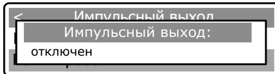
Повторным нажатием клавиши [ВВОД] производится включение/выключение импульсного выхода.
