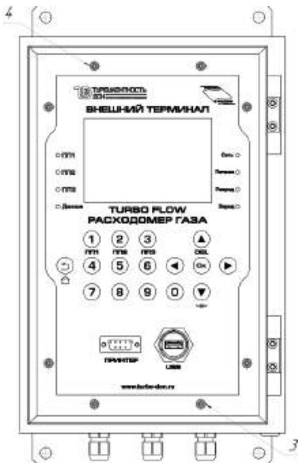
Рисунок Ж.4 – Внешний терминал в металлическом корпусе
