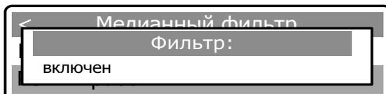
Повторным нажатием клавиши [ВВОД] производится включение/выключение фильтра.
