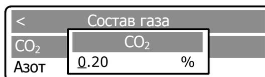
После установки значения нажать клавишу [ВВОД], на дисплей выводится сообщение об изменении параметра.
