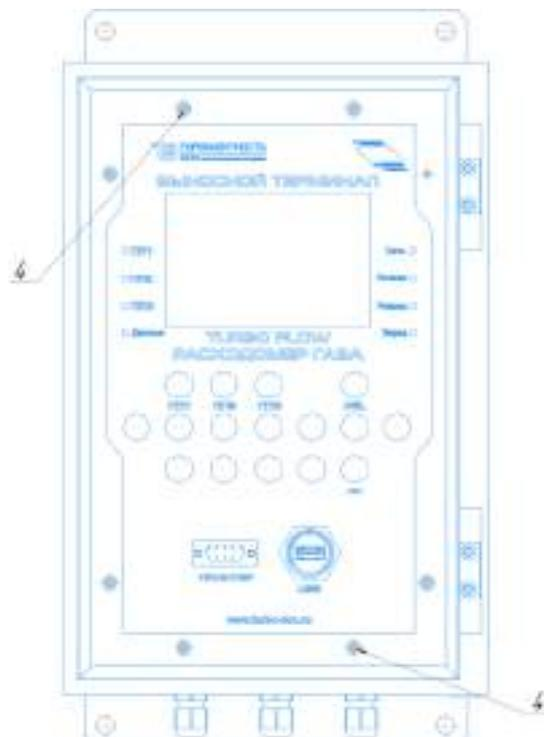
Рисунок Ж.7 - Выносной терминал в металлическом корпусе
