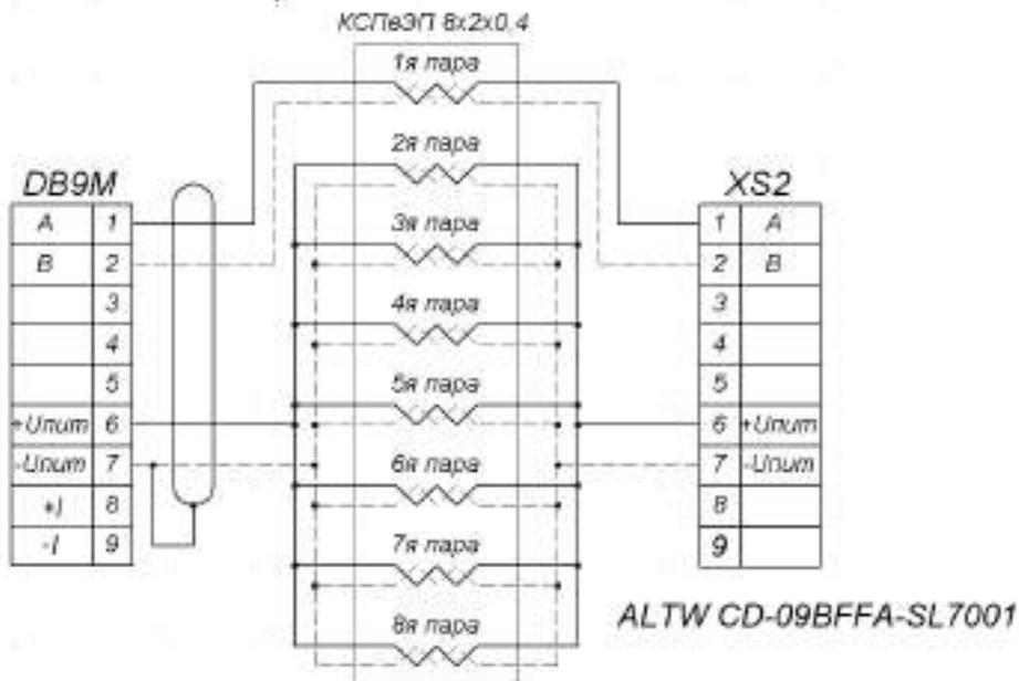
Рисунок Л.2 – Схема распайки кабеля КСПвЭП 8x2x0,4 для подключения ВТ и ПР
